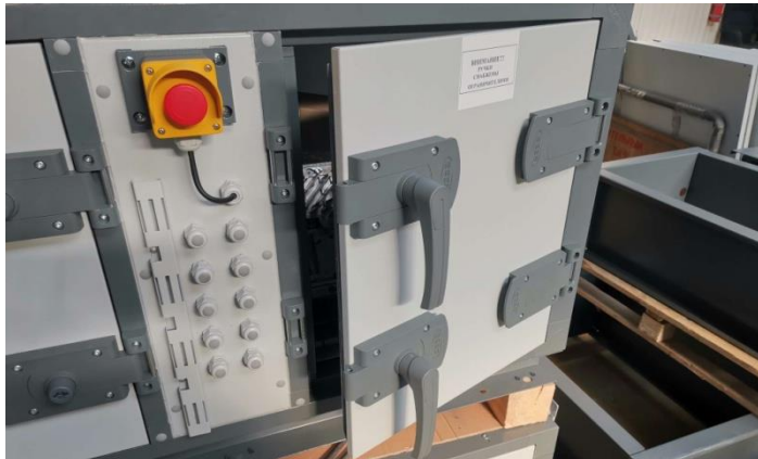
Рисунок 5. Запорный механизм вентиляторного блока.
