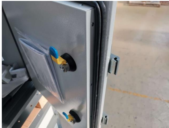
Рисунок 5. Запорный механизм вентиляторного блока.
